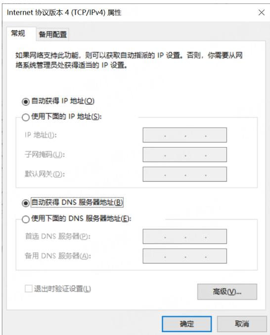
(2) 手动给PC配置一个跟设备地址在同一个子网的静态IP地址，单击并配置“使用下面的IP地址”；
